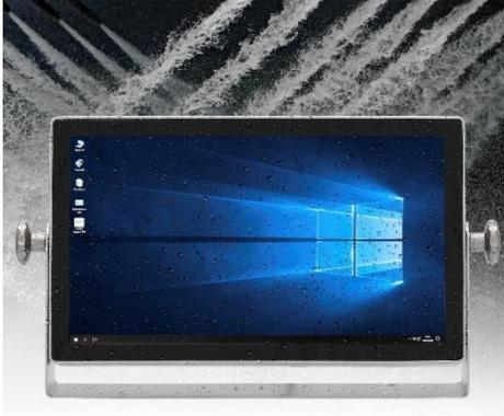
Neben der EXPERT SBC Baureihe mit analog resistiven Touch Screen, bietet FORSIS auch für Applikationen mit großem Visualisierungsbedarf bzw. immer da wo Anwendungen mit Gestensteuerung bedient werden können, eine **PCAP Multi Touch** Variante an.
