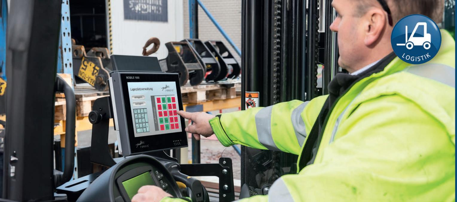
dafür die ideale Basis. Mit unserer lüfter- und plattenlosen Hardwareplattform erreichen Sie optimale Performance und Verfügbarkeit bei geringem Gewicht, minimalen Abmessungen und maximalem LCD-Sichtfeld. Und das in einem Temperaturbereich von standardmäßig  $-20\text{ }^{\circ}\text{C}$  bis  $+50\text{ }^{\circ}\text{C}$ , erweiterbar bis  $-30\text{ }^{\circ}\text{C}$ .
